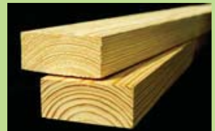
Figura: Arriba, pieza de la calidad Dense Select Structural de 2" x 4"; abajo pieza de la calidad No.1 NonDense de 2" x 4" pulgadas.
