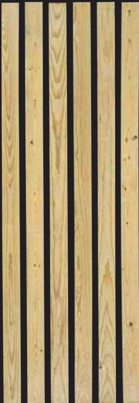
Figura: 5/4" x 6" Radius Edge Decking - R.E.D.; Longitud 10' (25mm x 140mm; longitud 3.048 m); Impregnado a presión en autoclave con protector hidrosoluble de Cobre, Cromo y Arsénico (CCA). A la izquierda calidad Premium, a la derecha calidad Standard.
