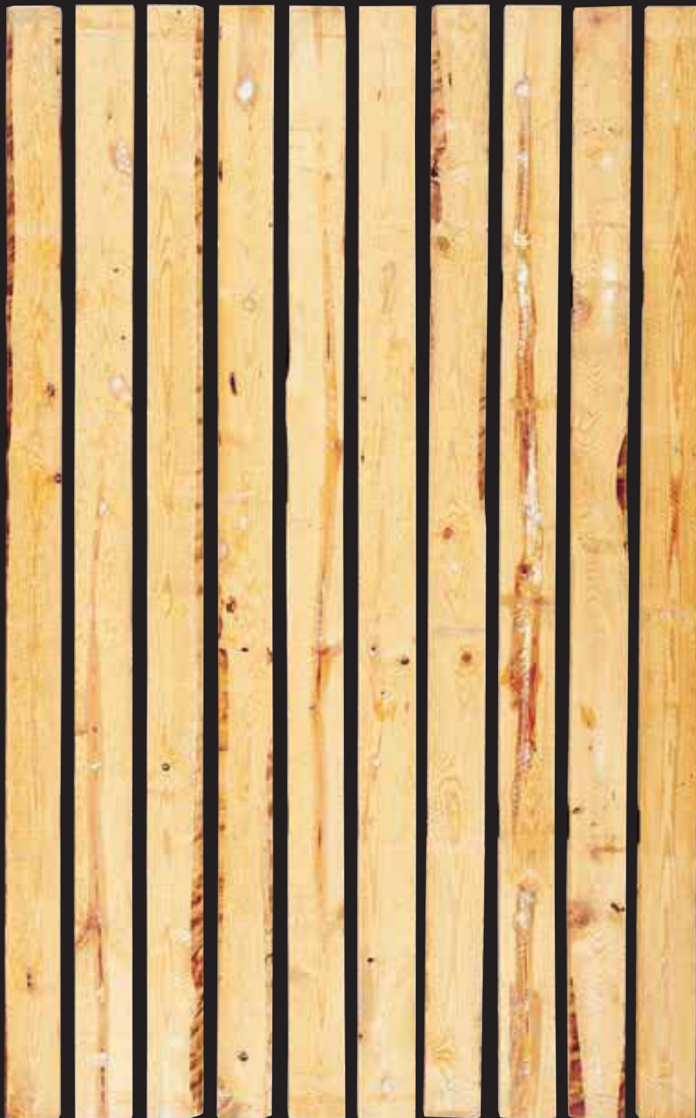
Figura: 2 x 6 No. 3 Construction Grade; Longitud: 10' 50mm x 150mm; Longitud: 3.048m
